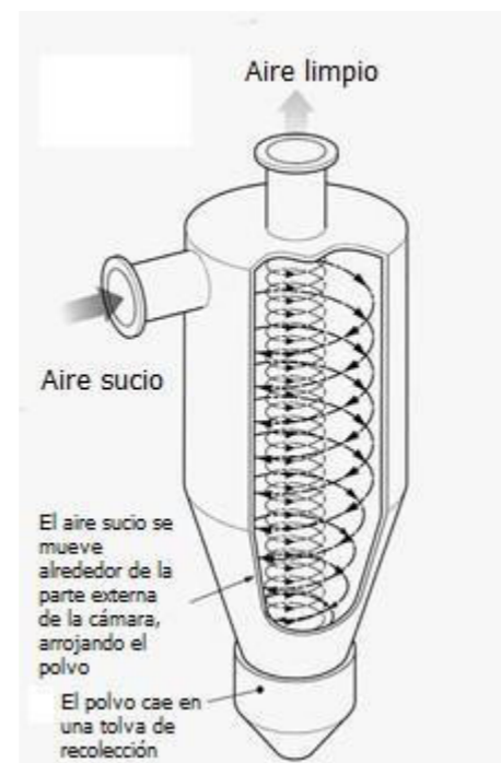
Fuente: HSE - Reproducido con permiso) Figura 5.23 - Esquema de un ciclón
