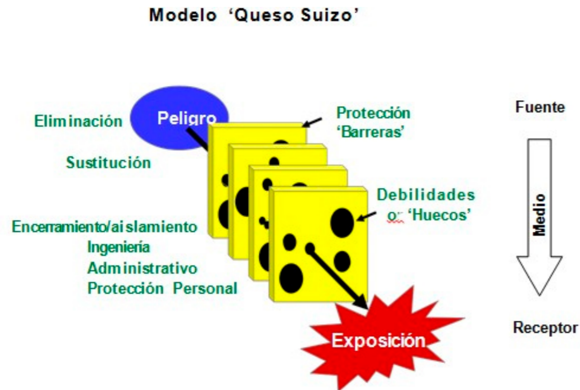
Figure 1.3 – El modelo "Queso Suizo" – Muestra la necesidad de múltiples medidas para el control efectivo
