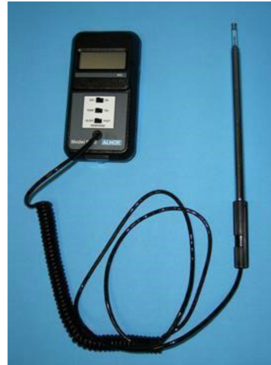
(Fuente: Universidad de Wollongong) Figura 5.28 - anemómetro de alambre caliente
