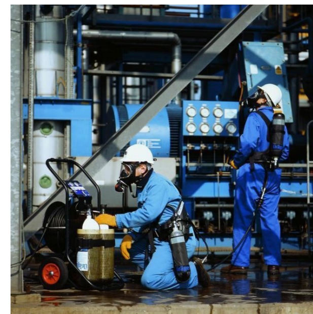
(Fuente: Dräger Safety Pacífico Pty Ltd - reproducido con permiso) Figura 7.7 – Respirador de línea de aire
