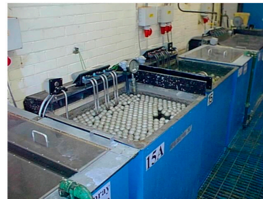
(Fuente: Diamond Environmental Ltd – reproducida con permiso) Figura 5.12 - Tanque de revestimiento con ranura de extracción a lo largo de un borde
