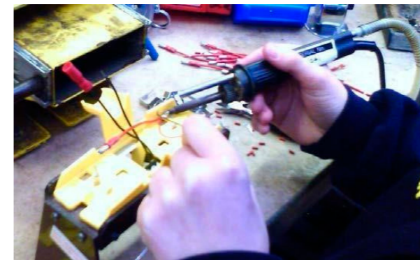
(Fuente: Diamond Environmental Ltd – reproducida con permiso) Figura 5.13 - Un Sistema LVHV utilizado en soldadura
