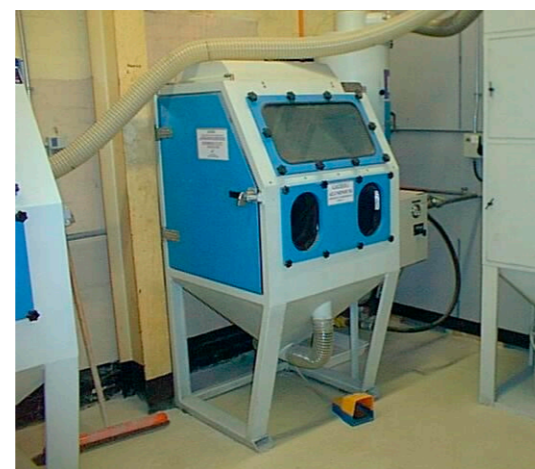
(Fuente: Diamond Environmental Ltd – reproducido con permiso) Figura 5.6 – Cerramiento Total de un Proceso de Limpieza con Abrasivos
