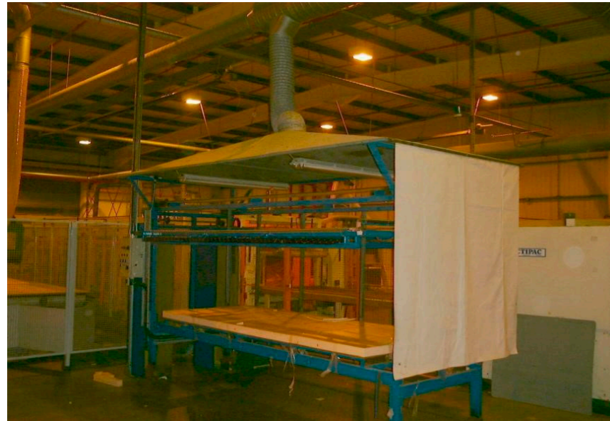
(Fuente: Diamond Environmental Ltd – reproducida con permiso) Figura 5.15 – Campana receptora para controlar neblina caliente de aceite y gas
