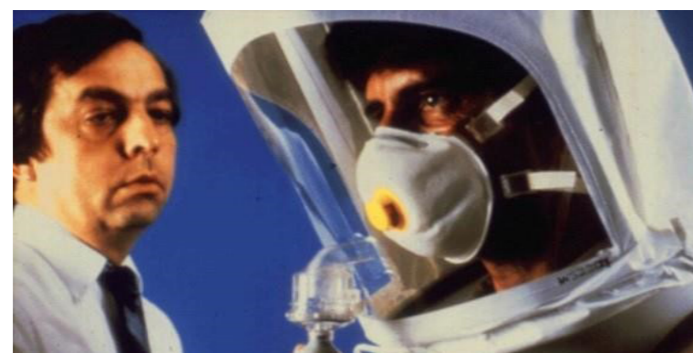
(Fuente: 3M Australia Pty Limited - reproducido con permiso) Figura 7.11 - Prueba de Ajuste Cualitativa con Sacarina o Bitrex
