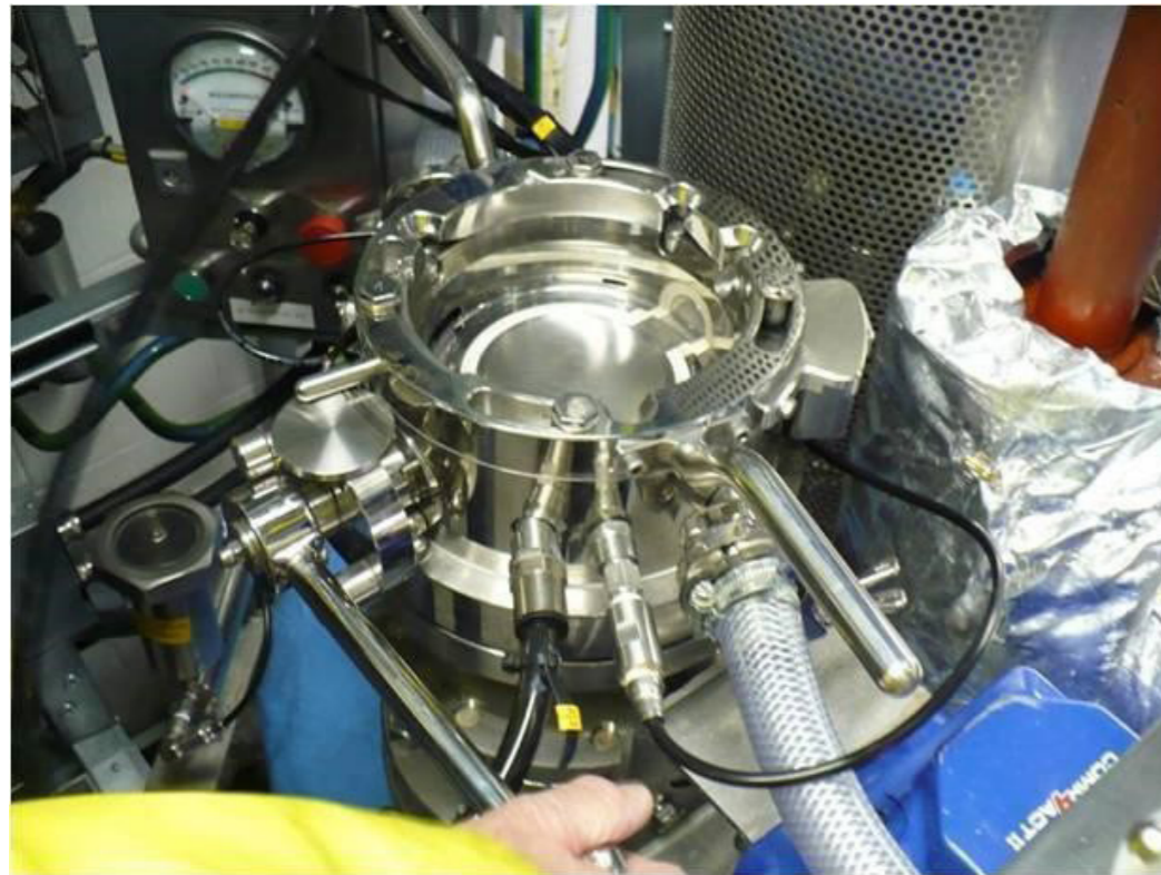
(Reproducido con permiso) Figura 9.15 - Puerto de acoplamiento fijo en recipiente de mezcla
