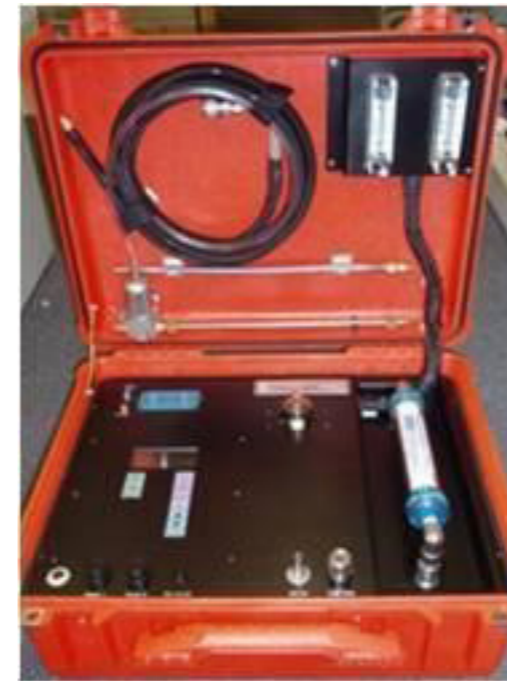
(Fuente: AQT Pty Ltd - reproducido con permiso) Figura 9.22 - Analizador portátil de partículas Diesel
