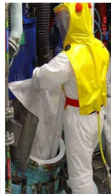
(Reproducido con permiso) Figura 9.16 - Carga del material en un recipiente de disolución
